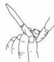
除去碱式滴定管乳胶管中气泡的方法
