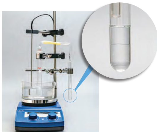
图 3.18 乙酸和乙醇的酯化反应
