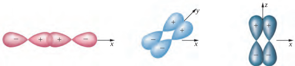
图 2.2 氮分子中原子轨道的重叠方式
