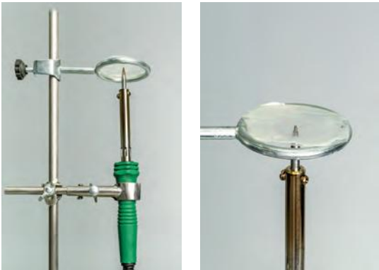
图 3.3 晶体的各向异性实验装置图
