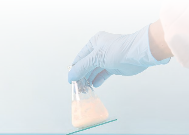
常温下，氢氧化钡固体与氯化铵固体的反应
