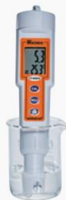
图 3-7 用 pH 计测量溶液的 pH
