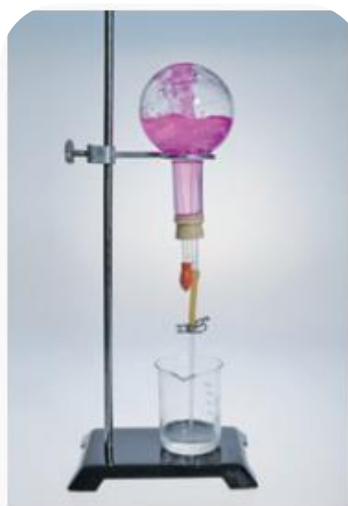
图 5-11 氨溶于水的喷泉实验
