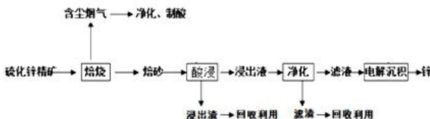
改进的锌冶炼工艺，采用了“氧压酸浸”的全湿法流程，既省略了易导致空气污染的焙烧过程，又可获得一种有工业价值的非金属单质，“氧压酸浸”中发生主要反应的离子方程式为 \_\_\_\_\_
