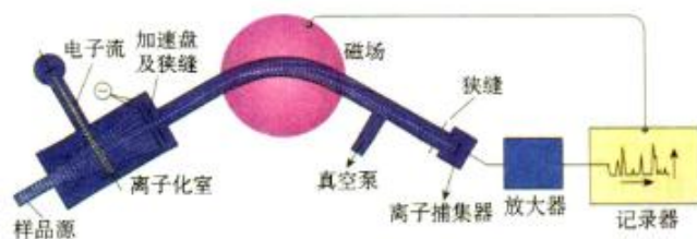
图 2-8 质谱仪原理示意图
