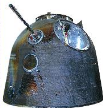
图 5-9 宇宙飞船返回舱烧蚀后外壳
