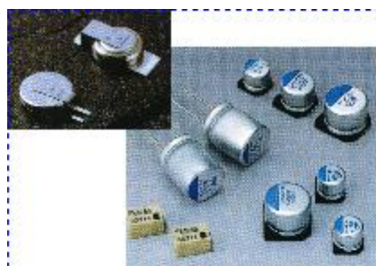
图 5-23 用导电高分子材料制成的电子器件
