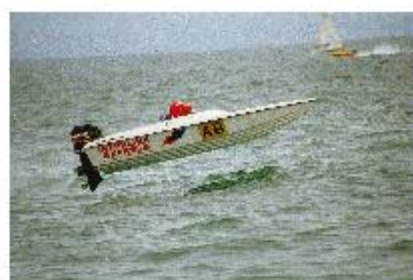
图 5-22 复合材料制成的船体
