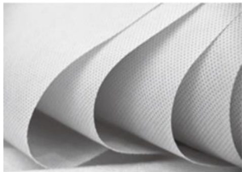
图 3 聚丙烯纺粘—熔喷—纺粘复合非织造布
